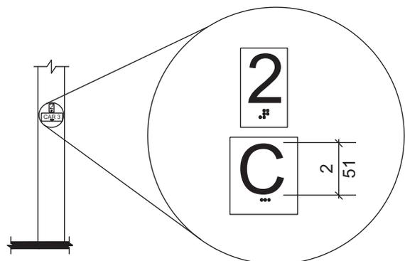
**FIG. 407.2.3.2 DESTINATION-ORIENTED ELEVATOR CAR IDENTIFICATION**
