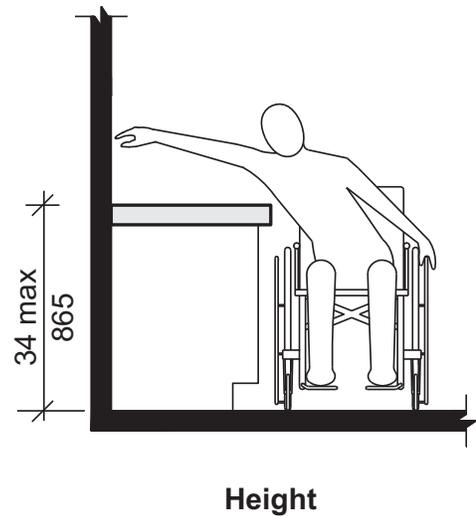
**FIG. 1004.11.3.2.1 LAVATORY IN TYPE B UNITS—OPTION B BATHROOMS**
