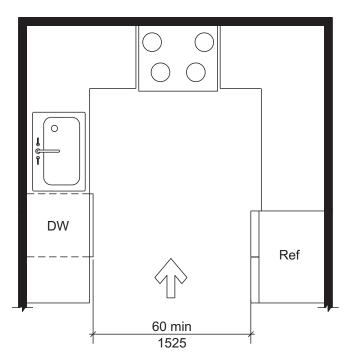
FIG. 1004.12.1.2 U-SHAPED KITCHEN CLEARANCE IN TYPE B UNITS
