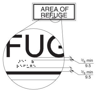
FIG. 703.4.4 POSITION OF BRAILLE
