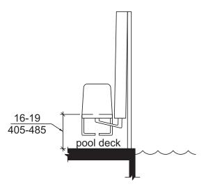
FIGURE 1109.2.4 POOL LIFT SEAT HEIGHT
