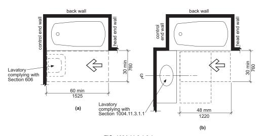
FIG. 1004.11.3.1.3.1 PARALLEL APPROACH BATHTUB IN TYPE B UNITS—OPTION A BATHROOMS
