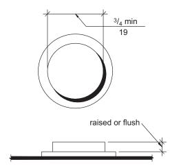
FIG. 407.4.6.2 ELEVATOR CAR CONTROL BUTTONS
