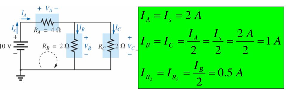
$$V_A = I_A R_A = (2 A)(4 \Omega) = 8 V$$
