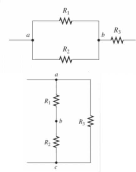
$$R_1 // R_2 + R_3$$
