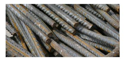
REINFORCMENT ADDS TENSILE RESISTANCE
