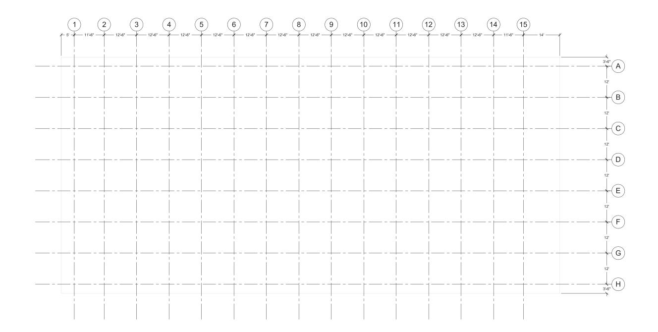
LAY OUT GRID LINES - USE THE CORNERS OF THE BASE TO ESTABLISH WHERE THE GRIDS START
